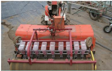
播種機は種子落とし部分を改良して、6~8条で使用する
