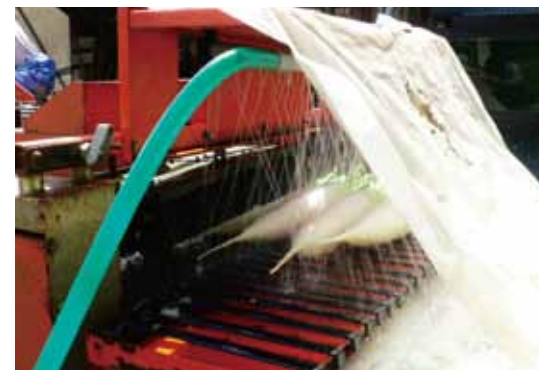
自動洗浄機で水洗いする
