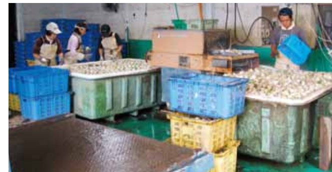
洗浄作業風景。右側の水槽で泥を落とし、洗浄機を通して左側の水槽へ。選別して出荷用のコンテナに入れる
